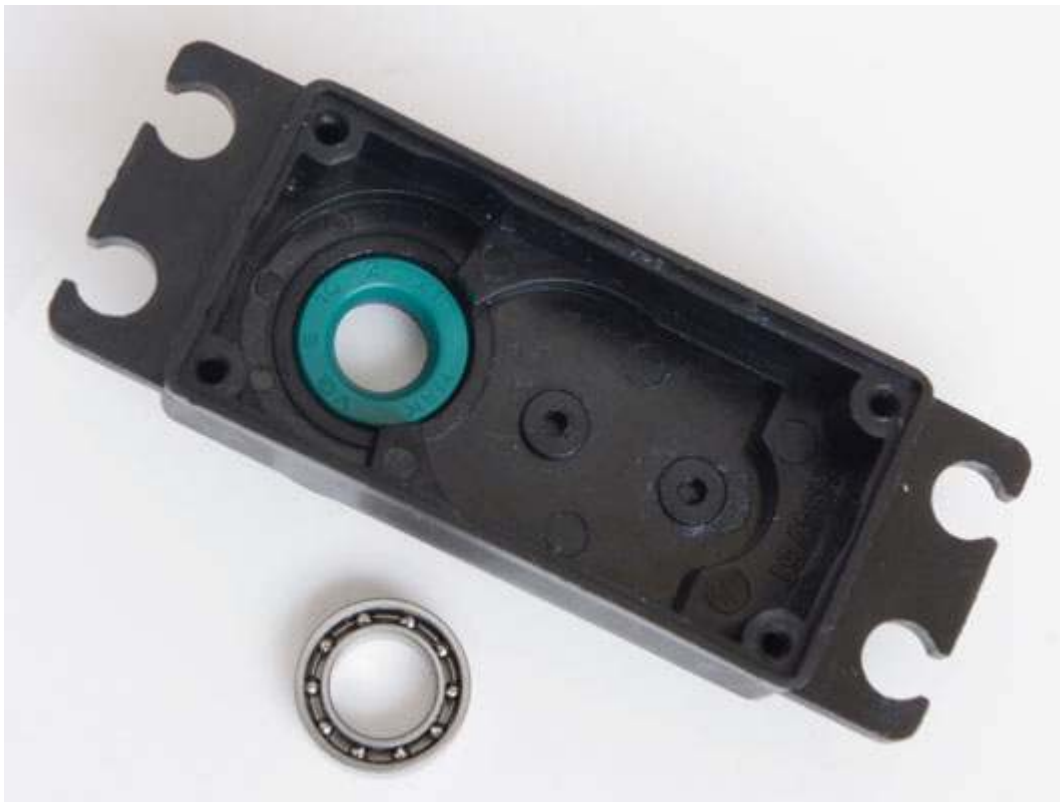
Gufero - náhrada původního ložiska namazaným guferem
