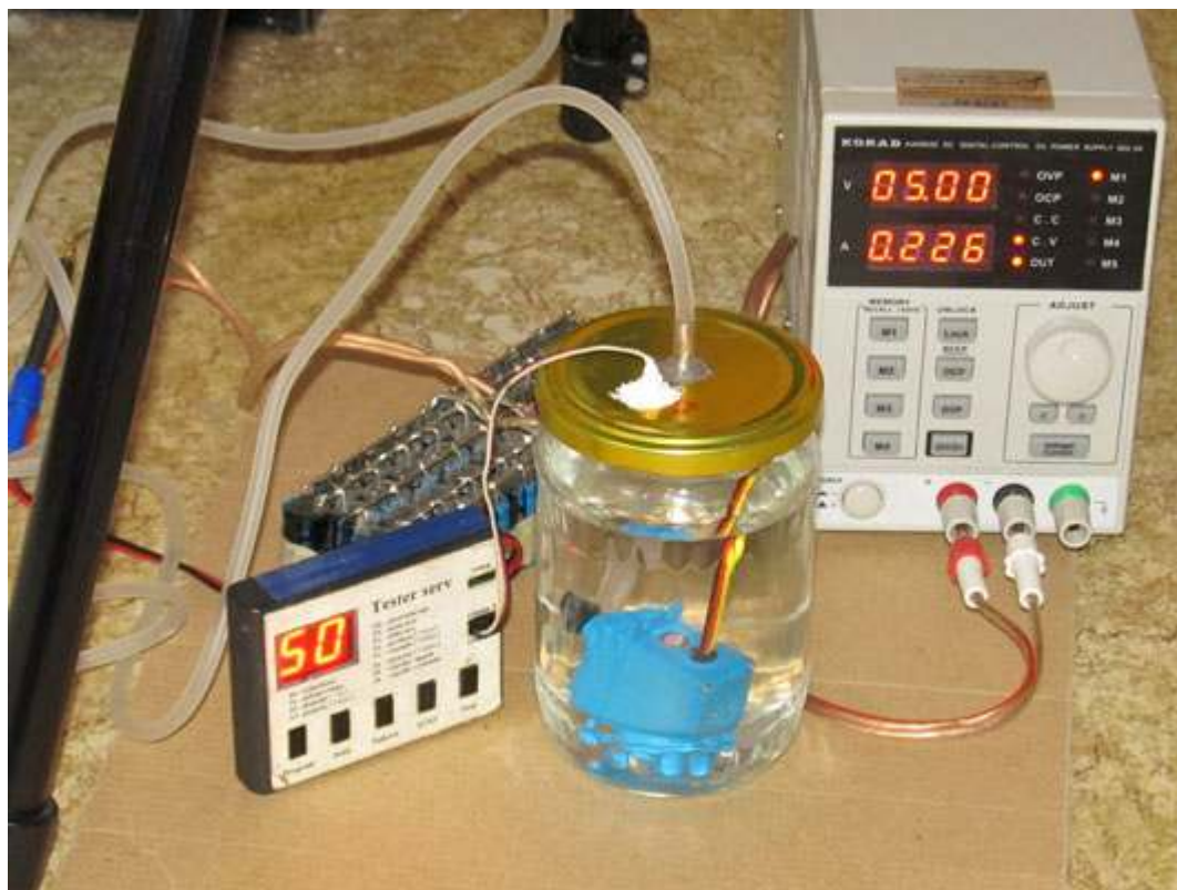
Zkouška těsnosti pod tlakem
