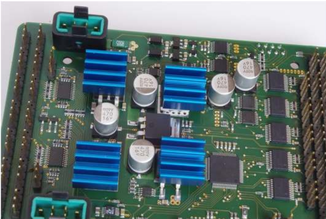
Část desky powerboxu osazeného polymerovými kondenzátory
